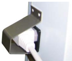
Рис.10 Кабель обогрева периметра двери и защита разъема кабеля.
